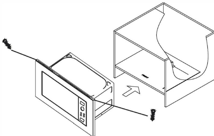
1. Поставьте микроволновую печь в шкаф и держите ее в горизонтальном положении, сохраняя одинаковое расстояние между двумя сторонами. Затем закрепите болт (компонент 1) на верхней части микроволновой печи и прикрутите его к шкафу
